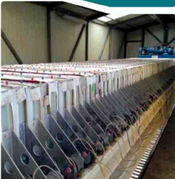
■ Traitement des boues issues du lavage des matériaux par presse à boues
